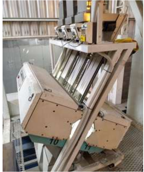
Figura N° 8: Colorimétrica en planta procesadora de garbanzo y specialities.
